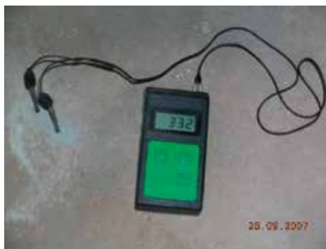
Abb. 2: Feuchtemessung, die Messzahl 33 entspricht 1,5 %
