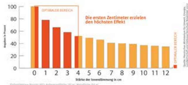
Schlanke Innendämmung Energieverlust durch die Außenwand
