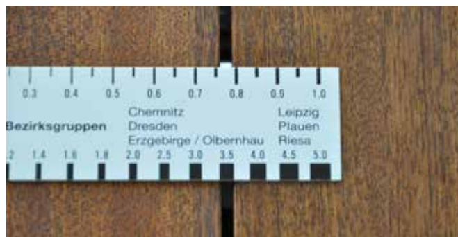
Abb. 1: Schwindverkürzung einer Massivholzplatte
