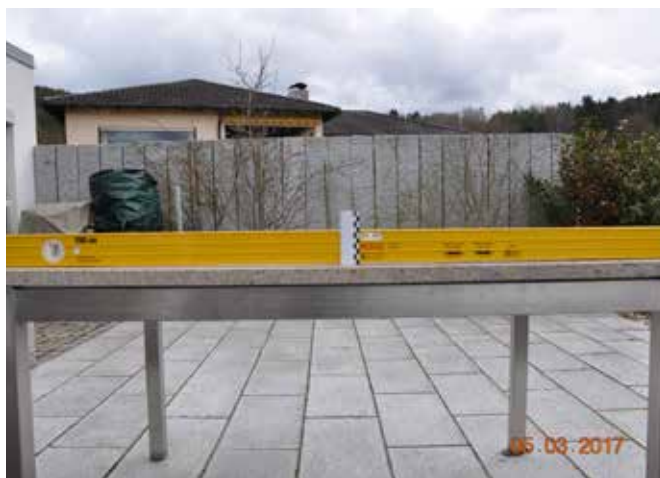
Abb. 10: Durchbiegung einer Tischplatte aus Granit
