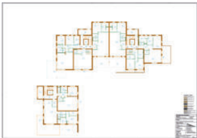
ELITECAD: Kennzeichnung von Wänden mit Brandschutzanforderungen
