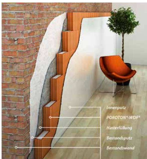
Die Wärmedämmfassade Poroton-WDF ist eine massive Ziegelwand, gefüllt mit dem natürlichen Dämmstoff Perlit. Sie ist einfach und sicher in der Verarbeitung und bietet hohen Brandschutz. Das System erfüllt alle Aspekte einer baubiologisch sinnvollen und ökologischen Wärmedämmung. Bild+Grafik: Schlagmann Poroton
