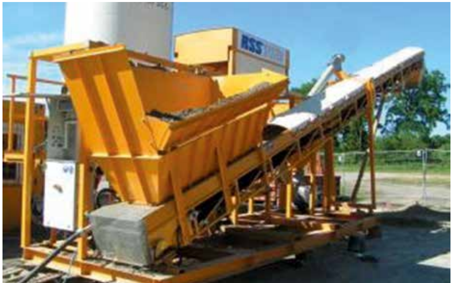
Anlage zur Herstellung von Flüssigboden
