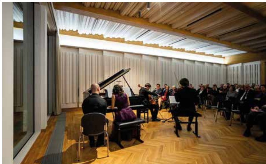
Ausformung und Schrägstellung der Paneele sorgen für ein optimales Klangerlebnis während eines Konzerts, sowohl bei den Besuchern als auch bei den Musikern und Musikerinnen. Foto: Seweryn Zelazny
