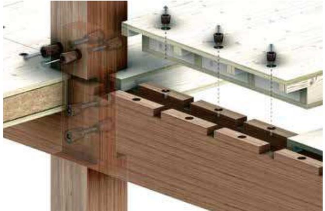
Abbildung 3: Demontierbarkeit – Beispiel im mehrgeschossigen Skelettbau auf Bauelementebene (siehe auch Abb. 2): Stütze, Unterzug (Zangenträger), Decke. Reversibilität durch Konusadapter. Quelle: t-lab
