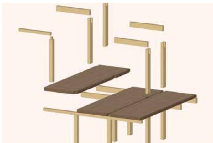
Eine einfache und rückbaubare Holz-Skelett-Konstruktion nach dem Baukastenprinzip. Grafik: Fast + Epp
