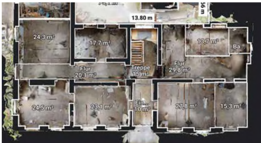
Ausschnitt Grundriss Erdgeschoss, erstes Ergebnis des 360°-Aufmaßes
