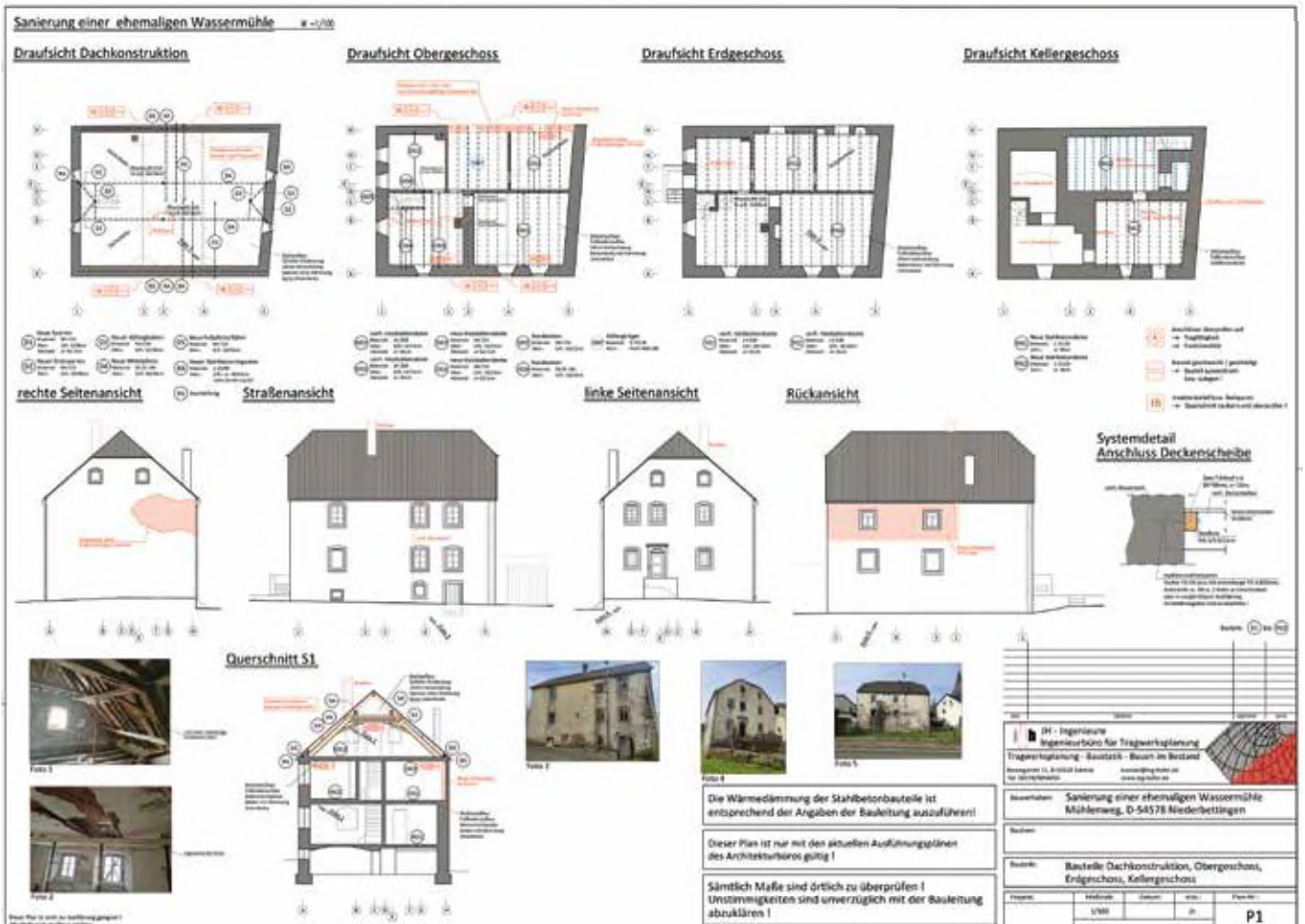
Sicherung der bestehenden Dachkonstruktion, sowie Ertüchtigung der bestehenden Holzbalkendecke über Obergeschoss
