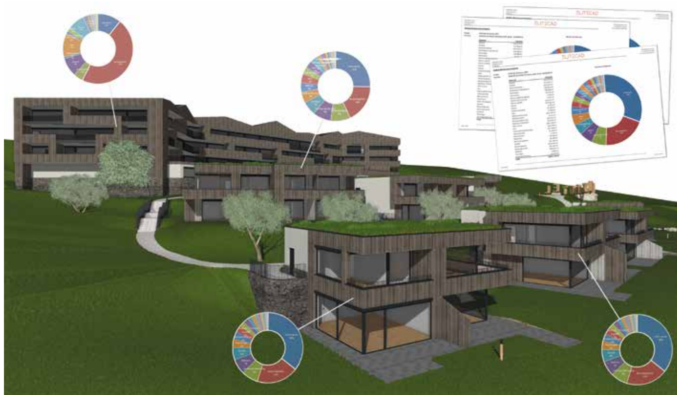
Auf Basis des digitalen Gebäudemodells erstellt ELITECAD Architecture 17 Auswertungen wie den Gebäuderessourcenpass, Materialanalysen und grafische Reports automatisiert. © XEOMETRIC GmbH
